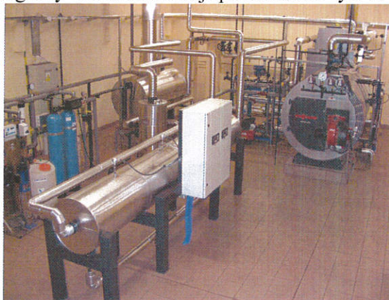
Rys. 1. Widok ogólny Instalacji do badań komputerowych układów do ciągłego nadzoru eksploatacji energetycznych kotłów parowych
