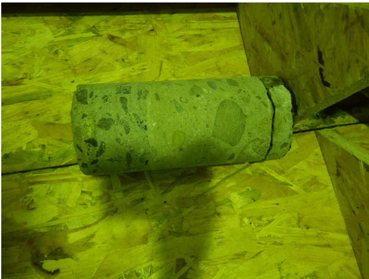
Fot. 6 odkrywka posadzki - wykonany przewiert
