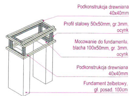
ŁAWKA 06 - KONSTRUKCJA AKSONOMETRIA 1:50
