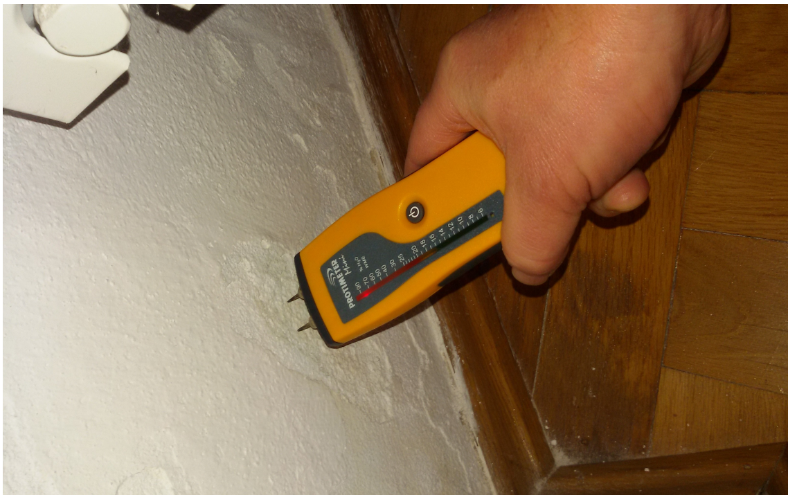
fot.5 pomiar wilgotnościerzem elektrycznym wilgotności ścian od wewnątrz (pomieszczenie F018)
