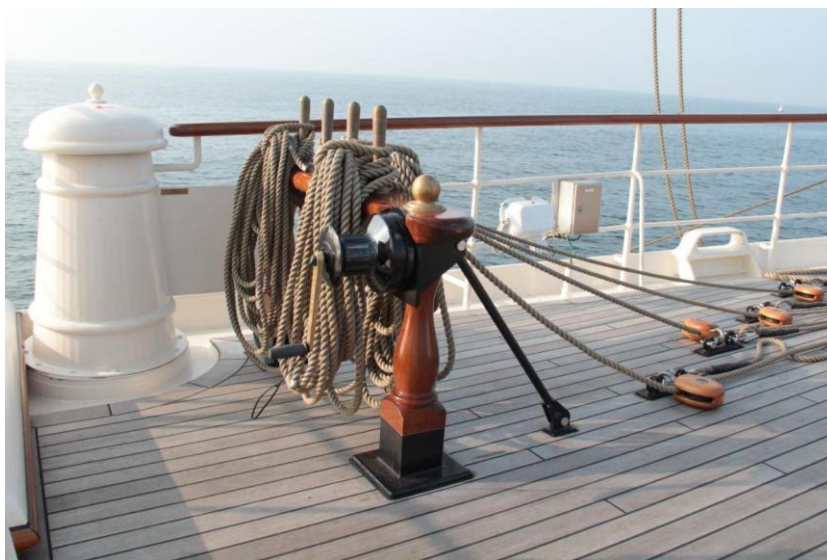
Rysunek 13 Przykłady typowego nagielbanku do szotów, fałów i niderholerów sztakli i kliwrów z kabestanem ręcznym.
